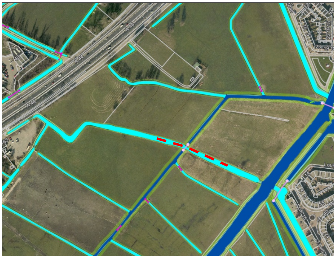
Figuur 5.1 Kruising boezemwatergang Stevenshofjespolder. Het te dempen deel is weergegeven met de rode lijn. (bron: uitsnede legger Hoogheemraadschap van Rijnland)
